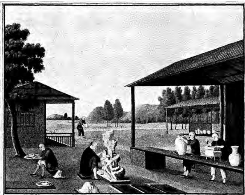
Afb. 283. Het maken van plastische stukken en het bijschaven van gedraaide en vierkante voorwerpen
